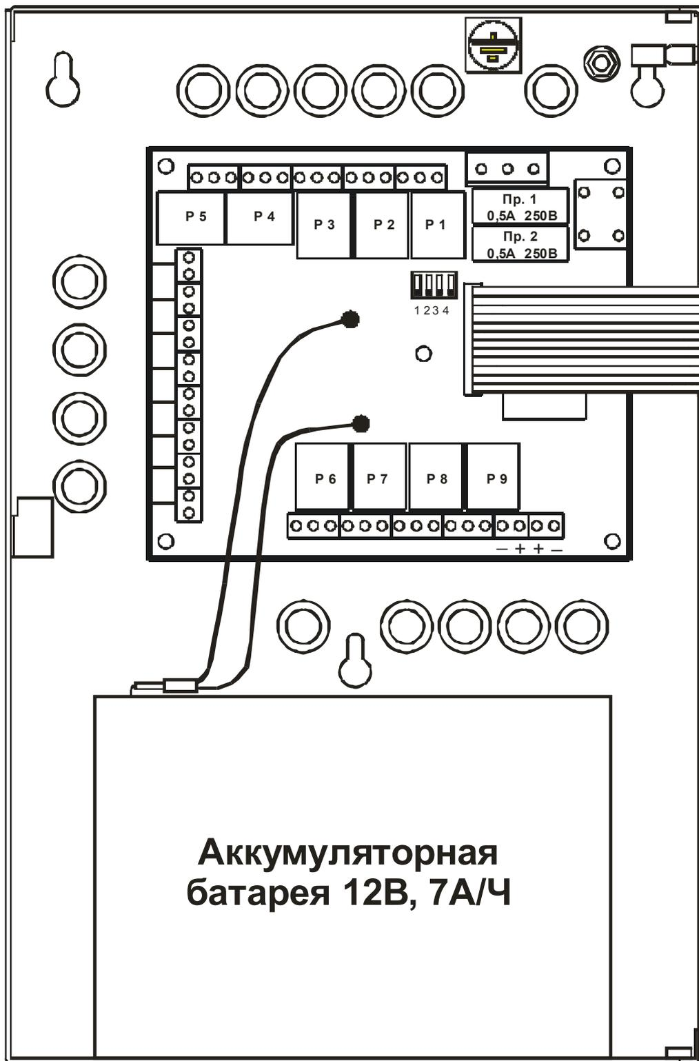
Размещение узлов в корпусе ППКП "ГАММА-108"
